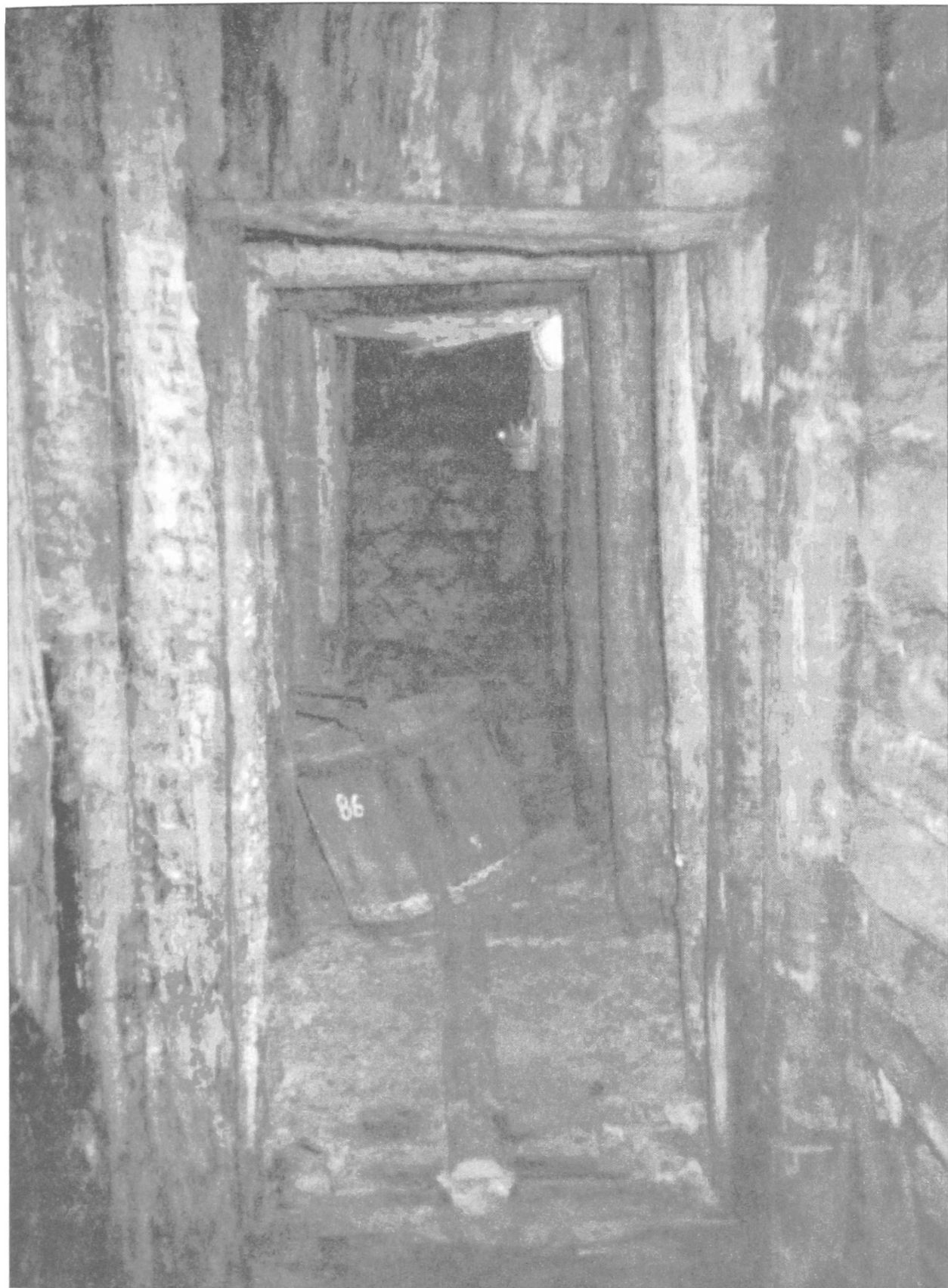
Rycina 4. Rekonstrukcja XIX wiecznego filara eksploatacyjnego (Częstochowa)
